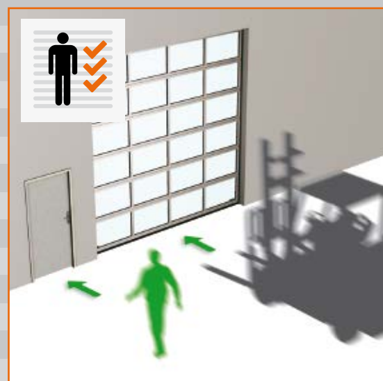
Portes d'accès distinctes pour les personnes et les marchandises.
