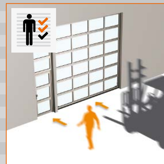
Portes d'accès distinctes pour personnes et marchandises dans la même baie.
