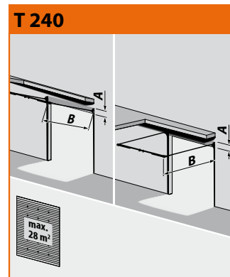
T 240 Système de rails à linteau réduit, câbles glissés à l'intérieur + profilé de support en acier
